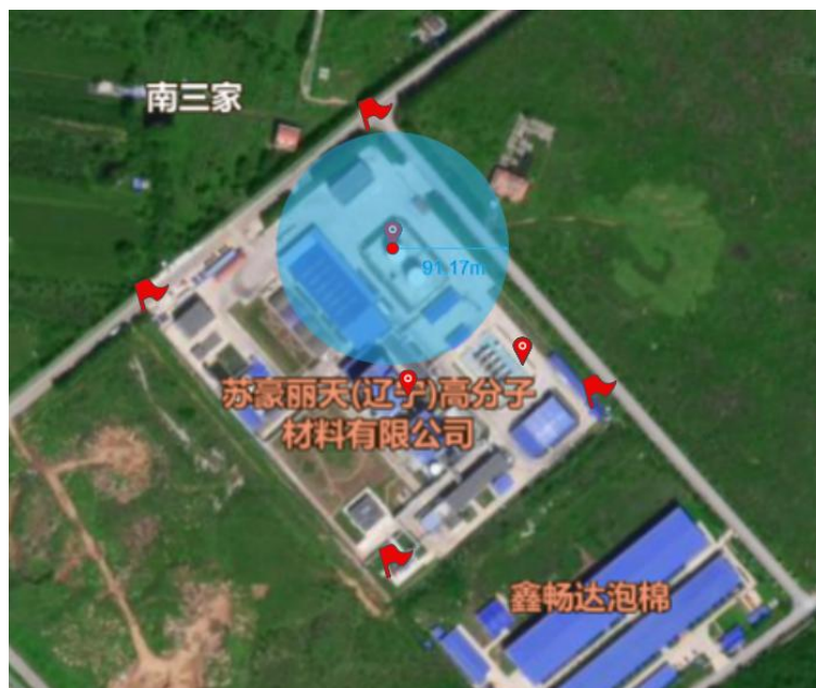
图 8-7 苯乙烯储罐大孔泄漏对压力容器的多米诺影响范围
