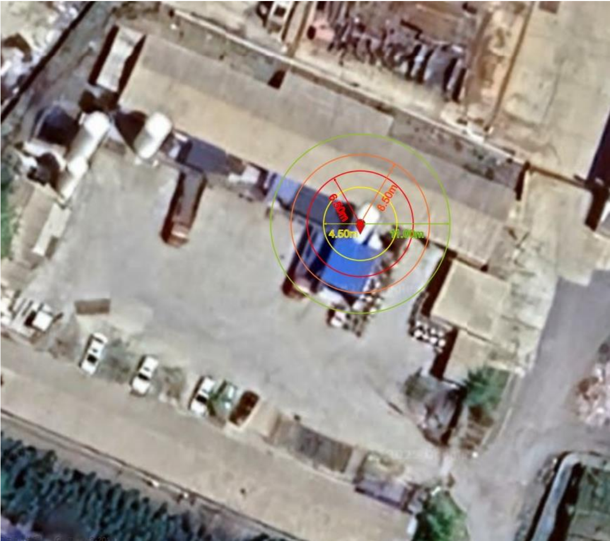
图 5-1 液氧储罐爆炸模拟图
