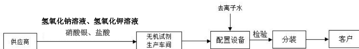
图2-3 硝酸银、盐酸、氢氧化钠溶液及氢氧化钾溶液经营流程示意图
