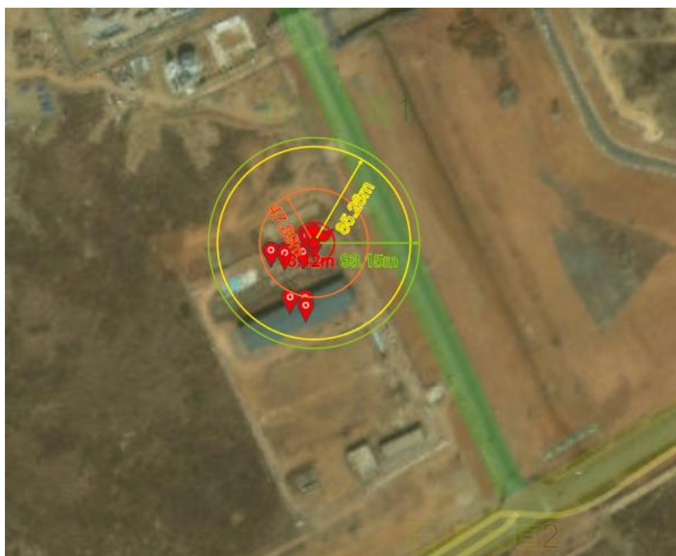
图 3.5-3 二氯甲烷储罐整体破裂导致蒸汽云爆炸事故影响范围示意图
