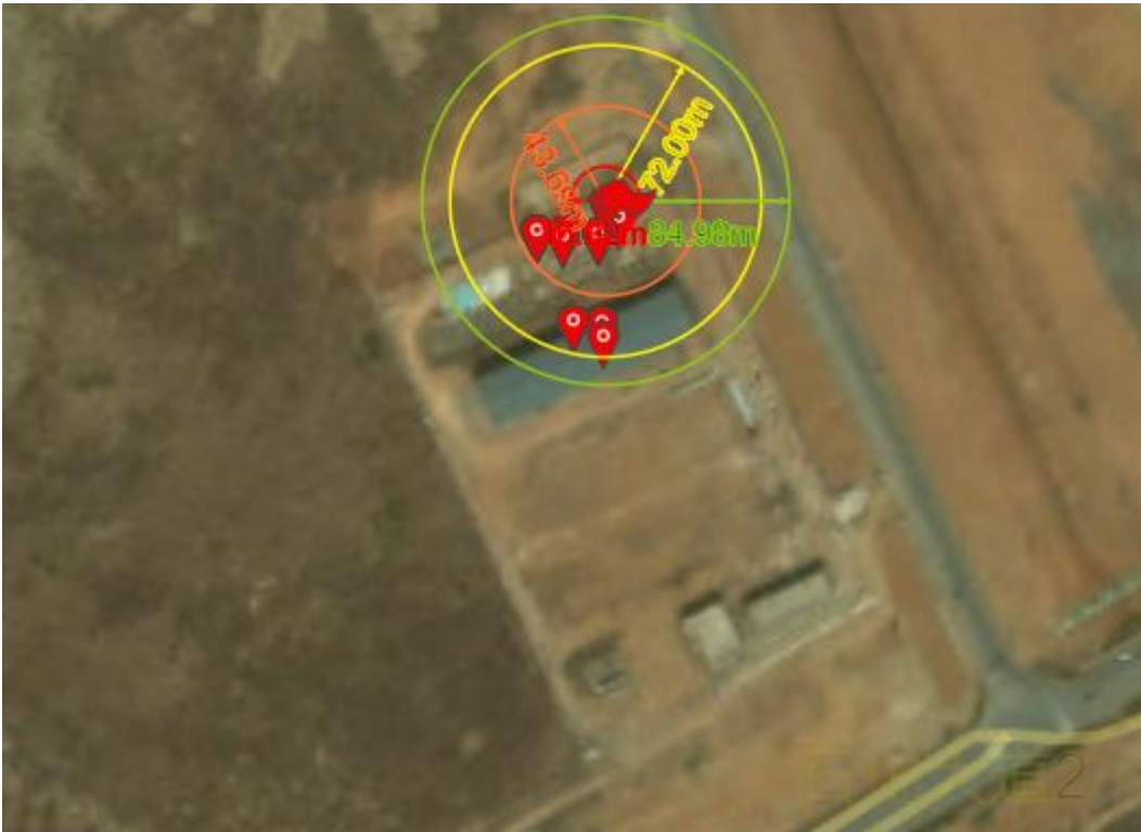
图 3.5-1 二硫化碳储罐整体破裂导致蒸汽云爆炸事故影响范围示意图
